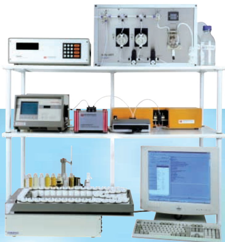
Système ASA-AROMA pour la détermination de la densité, l'indice de réfraction, la couleur et l'activité optique avec une capacité de 50 à 100 échantillons.
